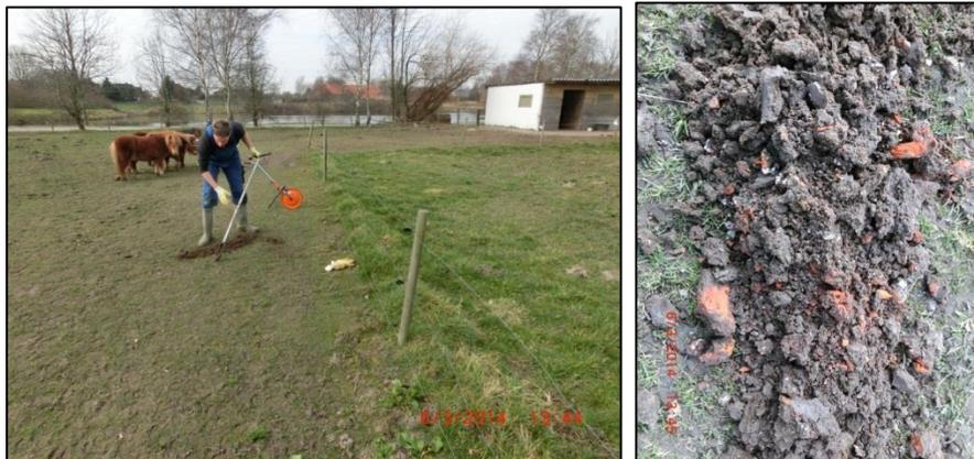
**Foto 11:** Bohrung B 11, Position innerhalb der Ponykoppel, Handbohrereinsatz
