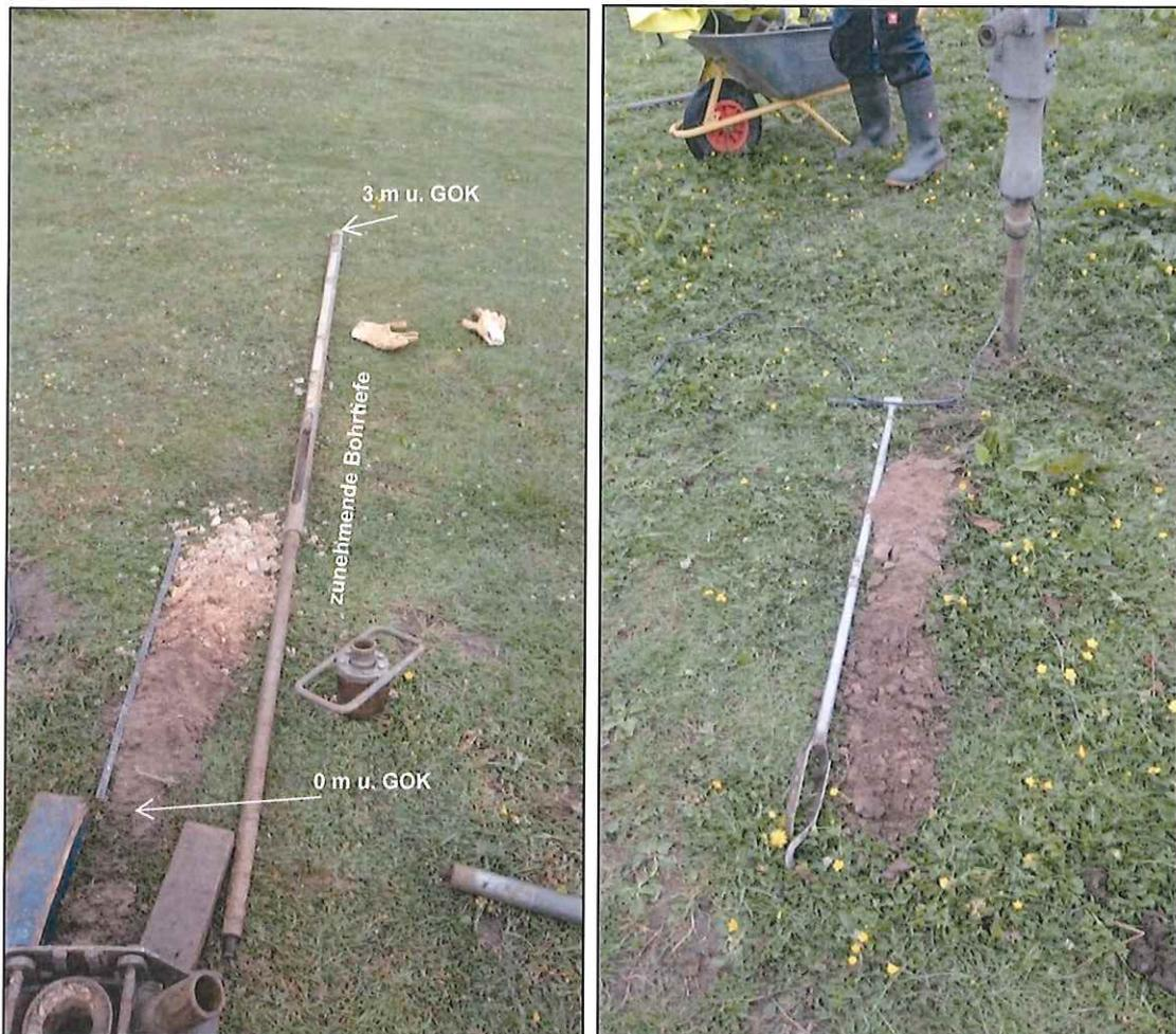
**Bild 3: Bohrpunkt B2, Gesamtprofil (Handbohrer zzgl. Rammkernsonde)**
